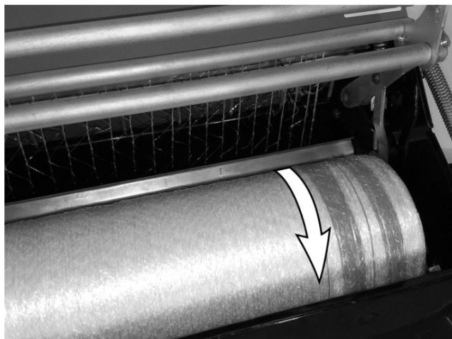
Obrázek 17 Síť se podává dopředu z horní části role
